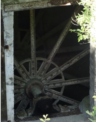
Mühlenrad, 6m Durchmesser
