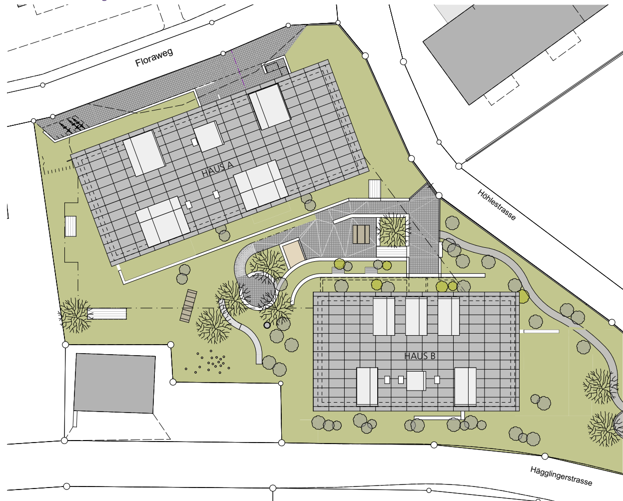
Photovoltaikanlage auf Dächer FloraPark
